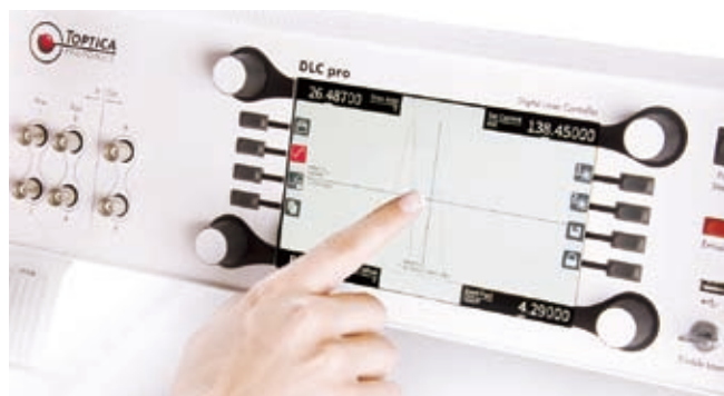
図2 タッチディスプレイは、測定データを可視化することができ、スキャンオフセット、スキャン振幅、ロックパラメータなどの重要パラメータを対話形式で調整できる。
